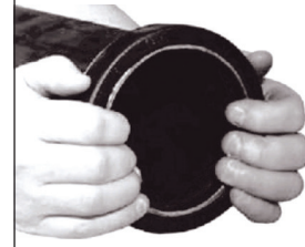
3. Conta montajı Gasket installation
